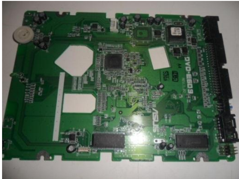
Figura2-Placa de Circuito Impresso com vários Componentes.
